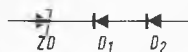
Bild 1. Prinzipschaltbild einer temperaturkompensierten Z-Diode bestehend aus einer Z-Diode und zwei normalen Si-Dioden
